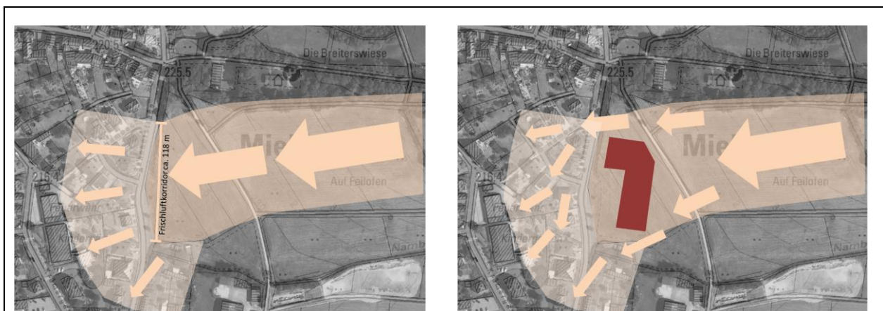
Abb.: Aktuell anzunehmender Luftstrom in die Siedlungslage in Abhängigkeit der Topografie Abb.: Anzunehmender Luftstrom in die Siedlungslage nach Umsetzung der Planung
